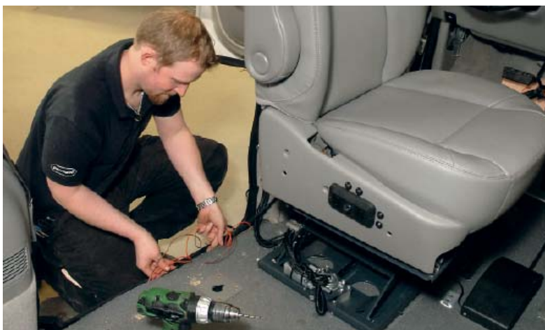
Robert Svensson arbetar med rullstolsrampen i en van med sänkt golv.
