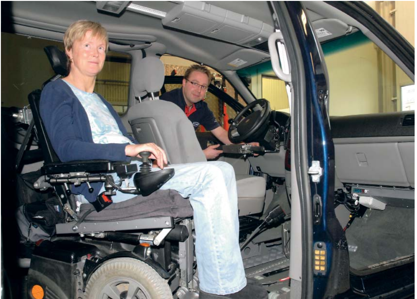
Franciska Darnell kan parkera sin rullstol på vilken plats som helst i bilen. Claes Philippen visar styrdonet, som kan ersätta ratt och alla pedaler.
