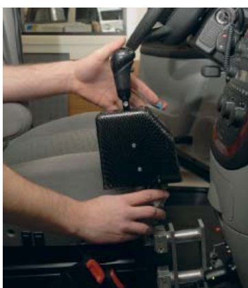
Med en liten joystick sköter man gas och broms.
